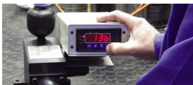
Diagnosi della pressione di spinta delle pressatrici.
