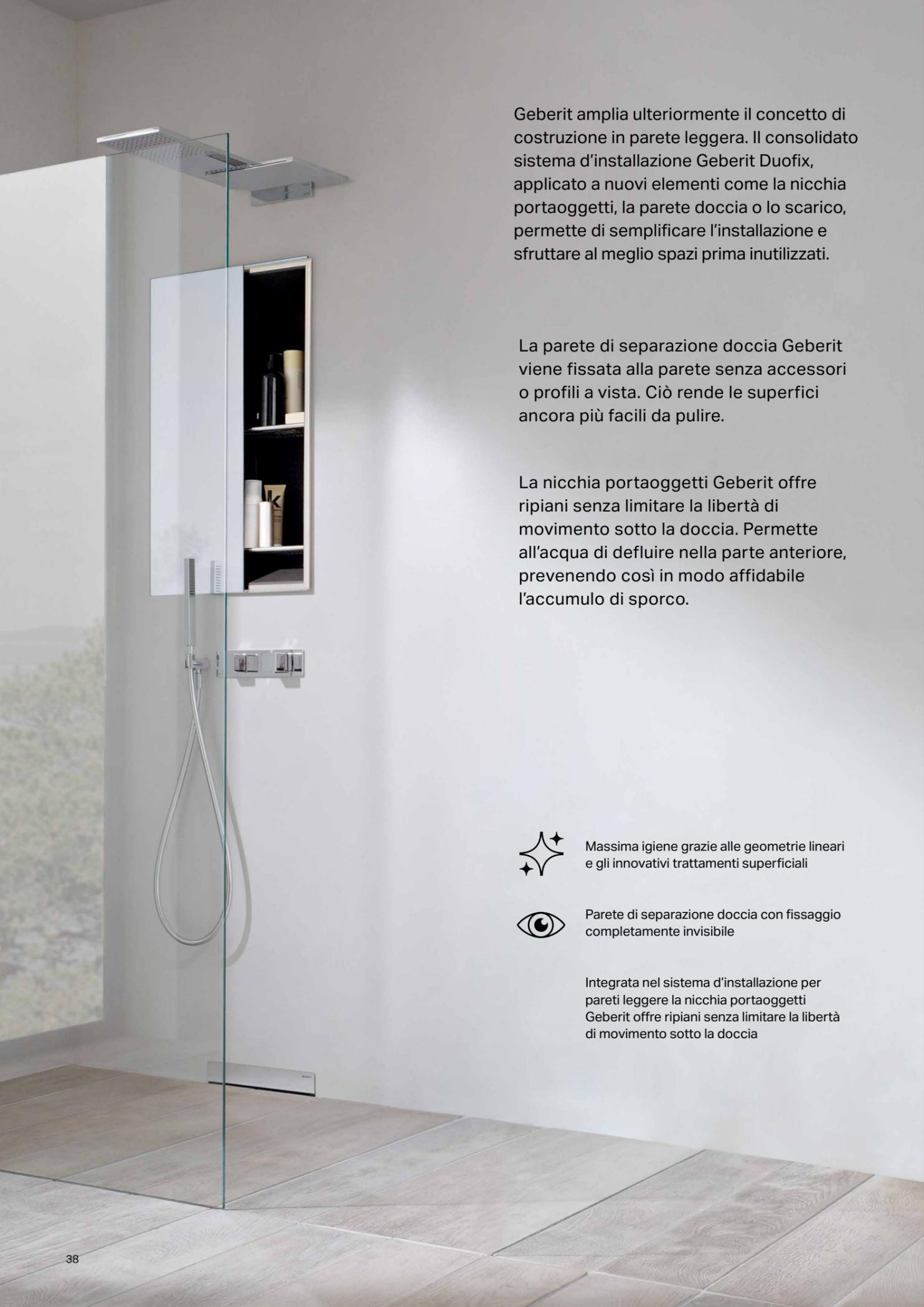
Geberit amplia ulteriormente il concetto di costruzione in parete leggera. Il consolidato sistema d'installazione Geberit Duofix, applicato a nuovi elementi come la nicchia portaoggetti, la parete doccia o lo scarico, permette di semplificare l'installazione e sfruttare al meglio spazi prima inutilizzati.
