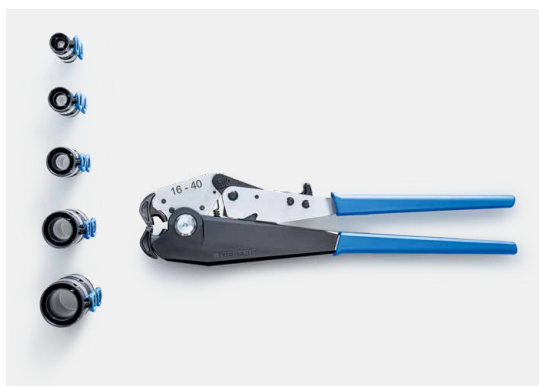
↑ La pressatrice manuale consente la pressatura di cinque dimensioni, da d16 a d40, e non richiede né batterie né alimentazione elettrica.
