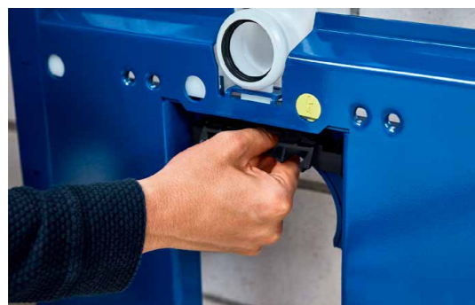
↑ La regolazione della curva di scarico è semplificata dal supporto telescopico che aiuta a posizionare la curva in avanti e indietro in linea con le esigenze di cantiere.
