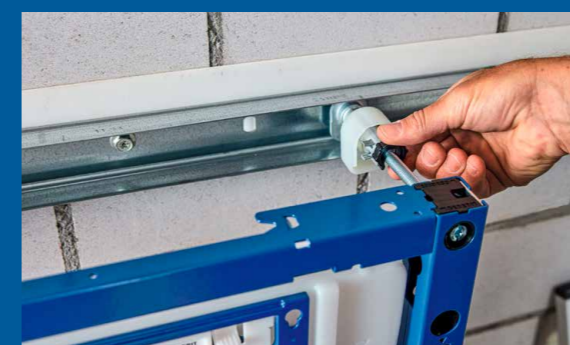
↑ Il fissaggio a parete è stato ridisegnato per un montaggio a rotazione a 45 gradi all'interno del binario. Il cappuccio bianco svolge tre funzioni: agisce da dima, serve come presa manuale per la rotazione, e, quando posizionato a muro, offre una superficie piatta per il contatto con il muro. Lo stesso fissaggio può essere utilizzato senza binario, sfruttando la base e utilizzando l'asola.
