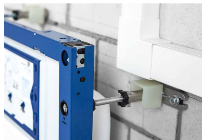
↑ Grazie allo speciale kit per il fissaggio alla parete, è possibile regolare la profondità di installazione comodamente lavorando di fronte al modulo d'installazione. Un doppio foro presente sul telaio è possibile scegliere dove collocare il fissaggio a parete quando ci sono ostacoli sulla parete.
